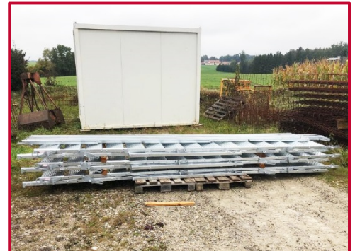
Um Transport und Lagerung zu vereinfachen, lassen sich die Bautreppen flach zusammenklappen.
