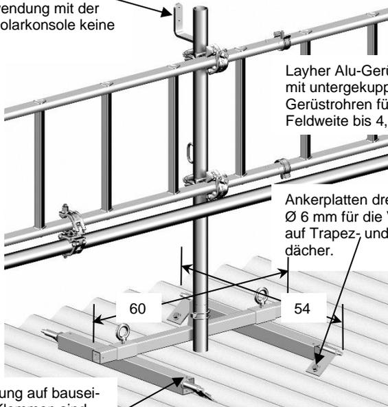
Layher Alu-Gerüstanlegeleitern mit untergekuppelten Alu-Gerüstrohren für eine geprüfte Feldweite bis 4,75 m.
